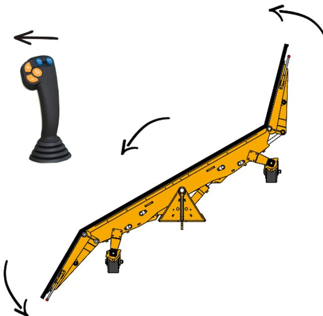
Wird der Joystick bzw. Kreuzhebel für die Hydraulik nach rechts gedrückt, sollen die Flügel oder der Grundträger (je nach Ansteuerung per z.B. E-Taster) nach rechts schwenken.
